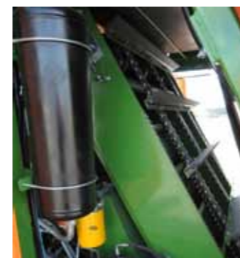
Скребковый транспортер для подачи мусора в накопительный бункер
