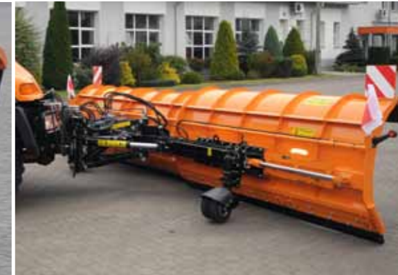
Способ крепления - коммунальная плита DIN 76060 тип А
