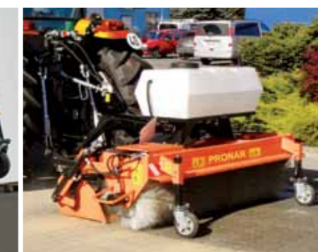
Система орошения для уменьшения пыле- и грязеобразования.
