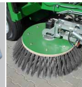
Регулирование положения дисковых щеток гидравлически.
