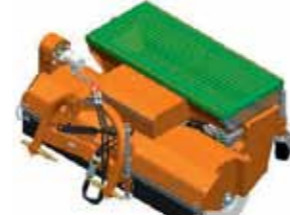
Гидравлический привод щётки и посыпающего вала пескоразбрасывателя
