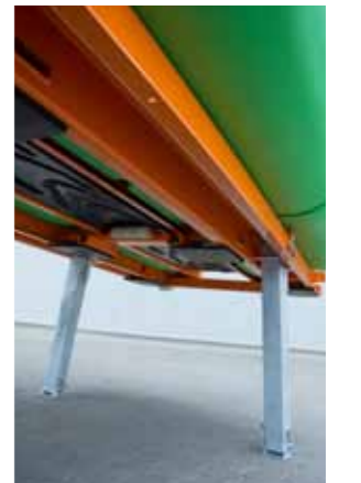
Система для облегчения загрузки пескоразбрасывателей РТ70 на платформу грузовика
