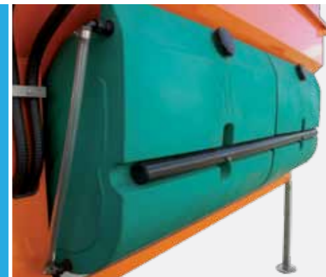
Бак для соляной смеси
