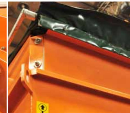
Надставки, увеличивающие размер загрузочного бункера. привод от пассивного колеса.
