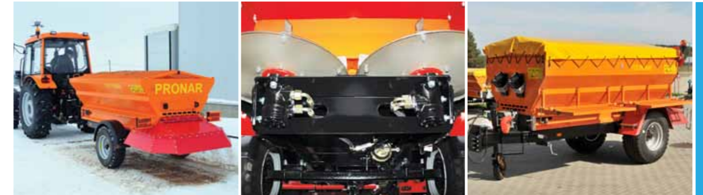
Регулируемая ширина разбрасывания. 2 разбрасывающих адаптера из нержавеющей стали. Боковая площадка для обслуживания
