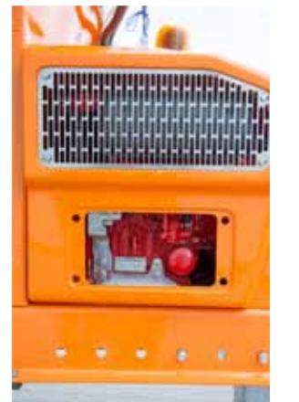
Двигатель внутреннего сгорания объемом 100 см 3 и мощности 16,2 кВт
