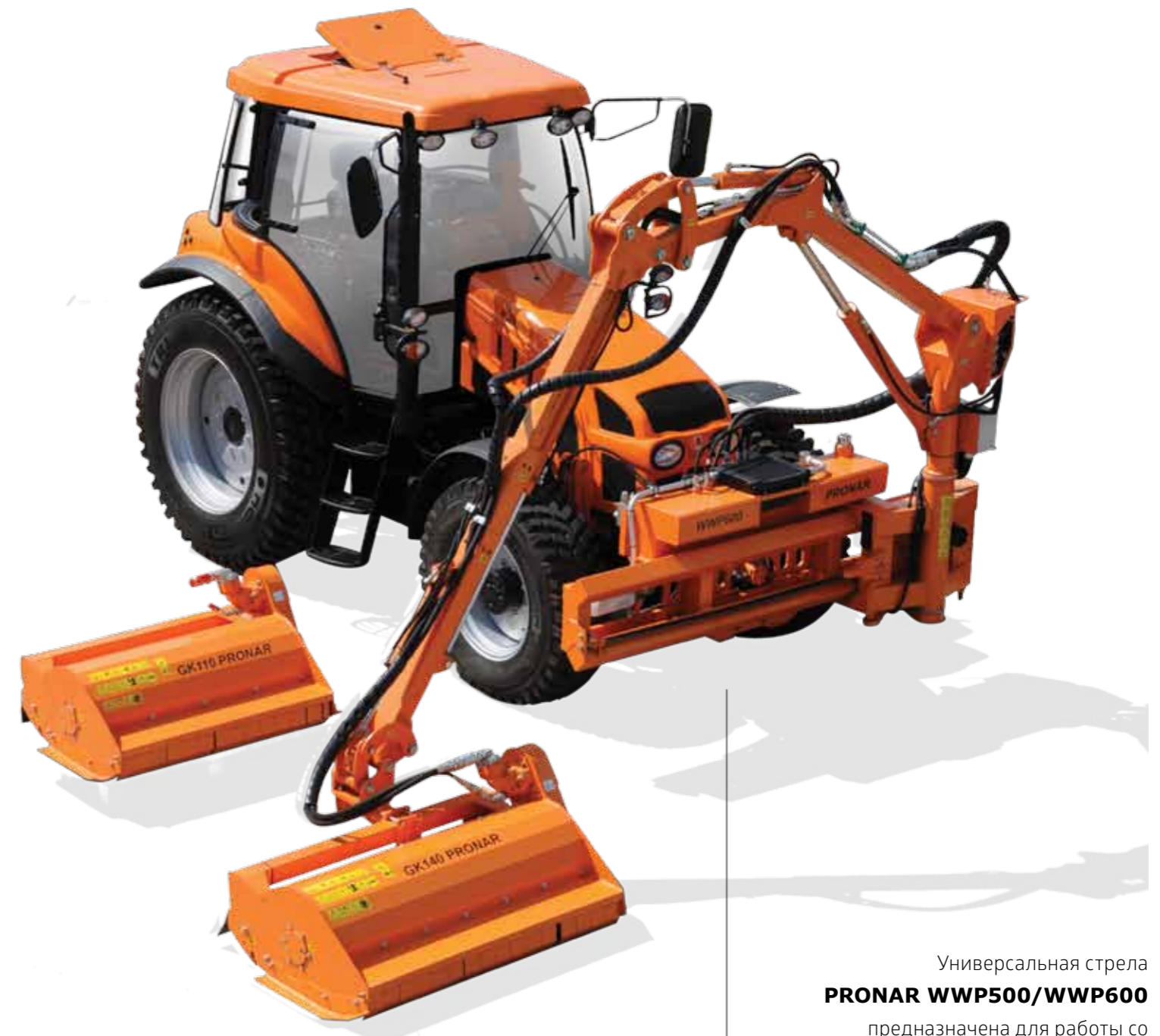
Стрела WWP600 – перемещение рабочего плеча по направляющей при помощи гидравлики.
