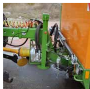
Дышло предназначено для агрегирования с верхним транспортным устройством
